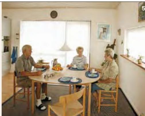
**4:** Candeeiro de tecto equipado com uma lâmpada fluorescente compacta de 18 W (cor 827) e boa difusão do fluxo luminoso, proporciona luz suficiente para que possa movimentar-se em segurança pela casa.
